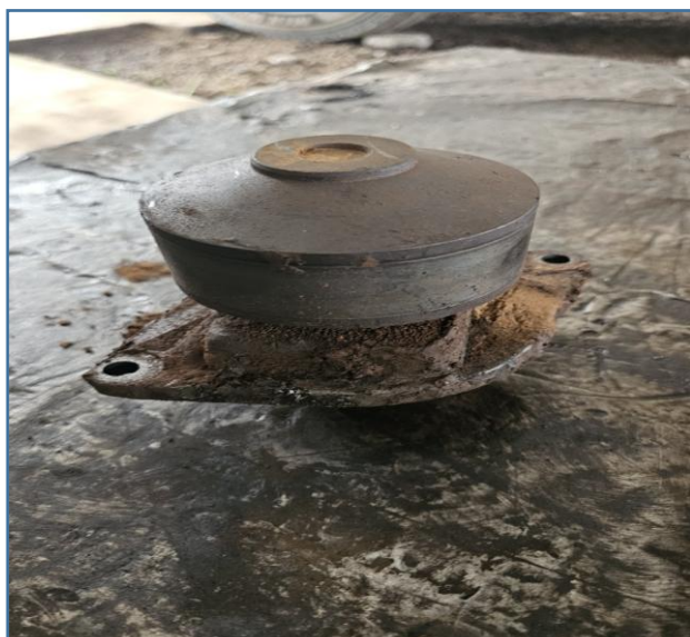
Imagem da bomba de água do motor
