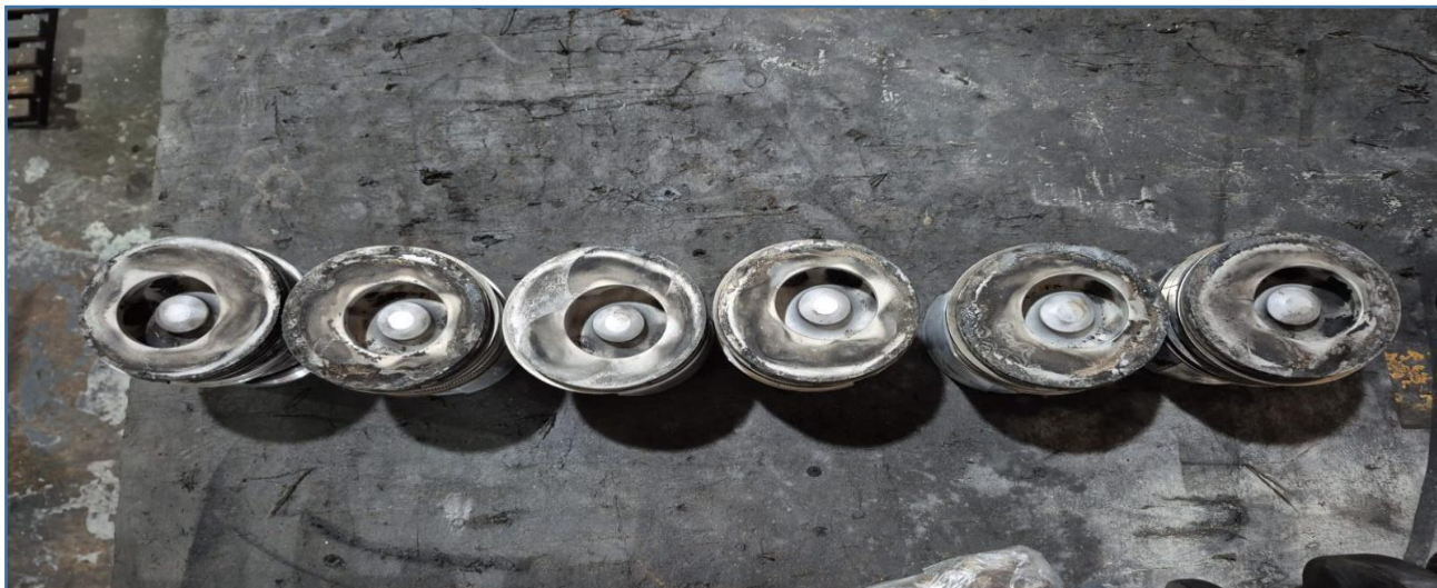
Imagem superior dos pistões e anéis do caminhão Volkswagen, estão danificados
