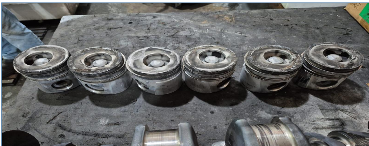
Imagem lateral dos pistões e anéis do caminhão Volkswagen, estão danificados
