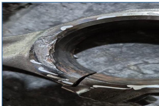
Imagem detalhada da biela danificada
