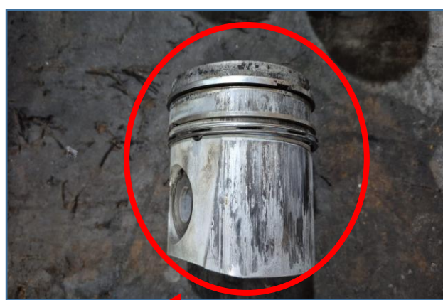
Imagens detalhadas com os danos ocorridos junto aos pistões e anéis
