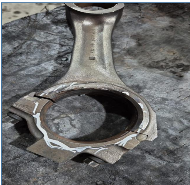
Imagem detalhada da biela danificada
