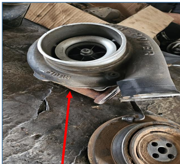
Imagens da turbina cuja qual deve ser substituída por estar com desgastes excessivos
