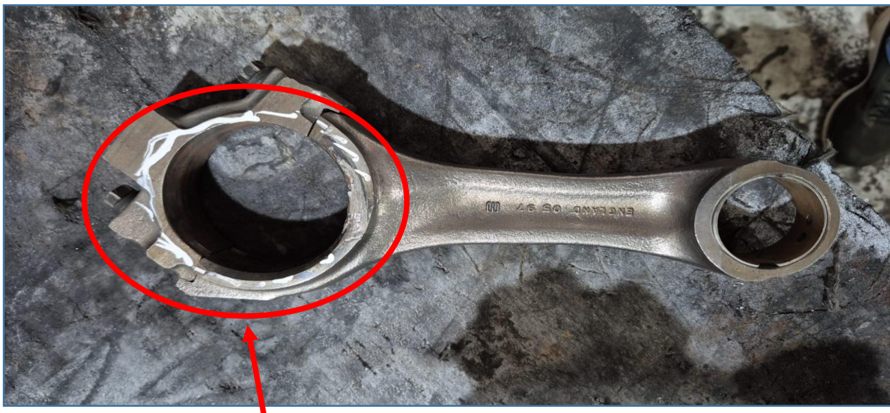
Imagem da biela do terceiro cilindro que danificou, a mesma foi a responsável pelos danos ocorridos junto ao motor
