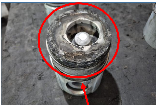
Imagens detalhadas com os danos ocorridos junto aos pistões e anéis
